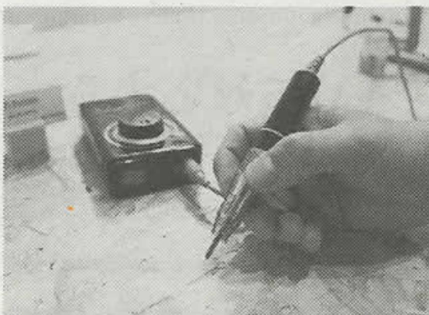
タイプ「M1ポータブル」では、ハンドピーストルクの高さも特長の一つ。「M1ポータブル」では、8・5 N・mという同クラスでは最大のトルクを発揮する。最上位機では24・7 N・mまで発生させることができ。低速でも十分なトルクが得られるため、 安定した切削・研磨加工が可能となる。
